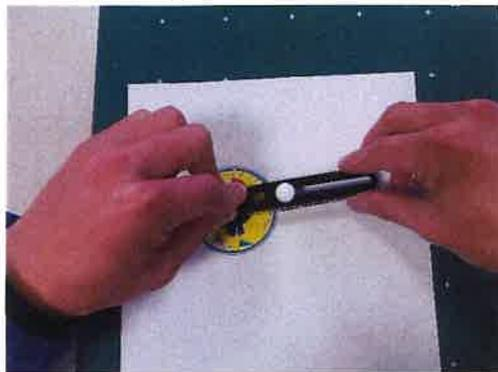
3 台紙, 保護シート, バッジを缶バッジマシーンにセットする。
