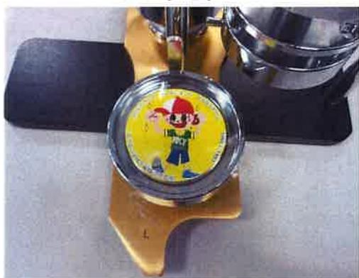
4 缶バッジマシーンにセットしたらプレスする。
