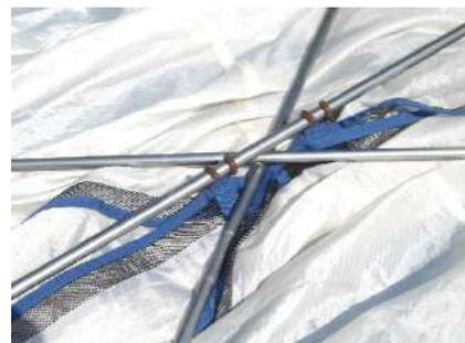
④棟支柱の中心を、長い2本の支柱のクロス部分に置き、フックを回して止める。
