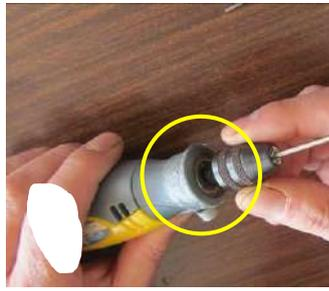
ロックボタンを押しながらルーターの根元を左に回し、芯を先端に差し込む。まっすぐ差し込まれていることを確認してから、根元を右に回して固定する。
